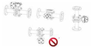
f) 阀门密封圈材质为三元乙丙橡胶,通过压板固定在蝶板上,密封圈凸出蝶板,如果在阀门开度 大于8%时,极易受到碰撞、挤压、摩擦、划割、烤烧等被动损伤,建议阀门安装完成之前保持出 厂开关状态:
